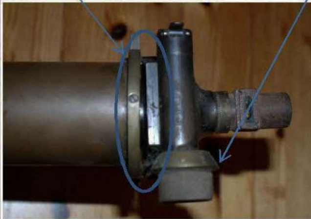
Eine von drei Befestigungs- schrauben fehlt, der Kopf ist lose
