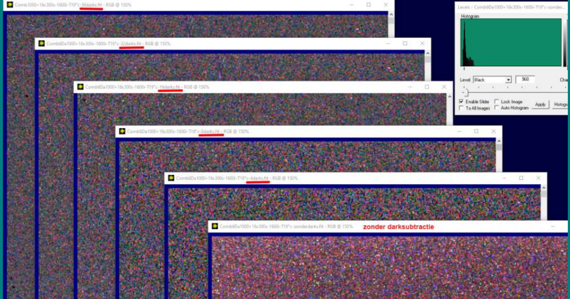
Weergave gekalibreerde 6Da stack (16 x 300s-1600iso-temp 19°C) met verschillende masterdarks. (weergave 150% - stretch; zwart 960 ADU – wit 1100 ADU)
